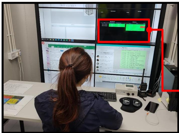
「物联网环保监察系统」由噪音及尘埃的物联网(IoT)传感器所组成，被安装于地盘邻近医院的位置，以确保「无滋扰工程」的实行。该系统会全天候监测附近环境的噪音水平及悬浮粒子含量。如有数值超出标准，警告讯号会被立即传送至控制中心，以便采取及时行动。
